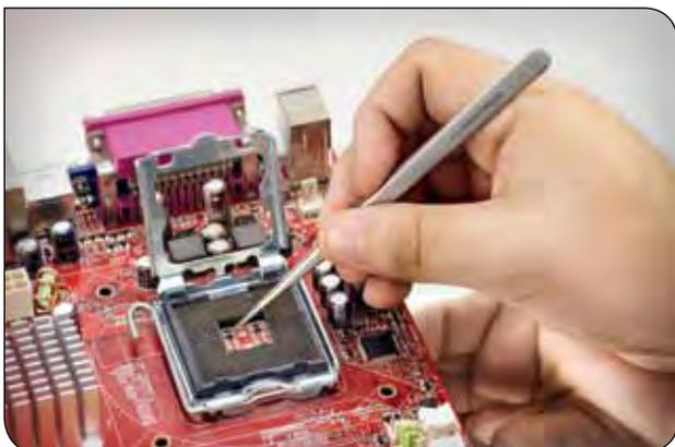
Une large diversité de matériaux existe: carbone acier, acier inoxydable, acier spécial inoxydable, nickelé, et même béryllium et titane. Cependant, pour la plupart des montages ou réparations, les trois premiers modèles suffisent :
