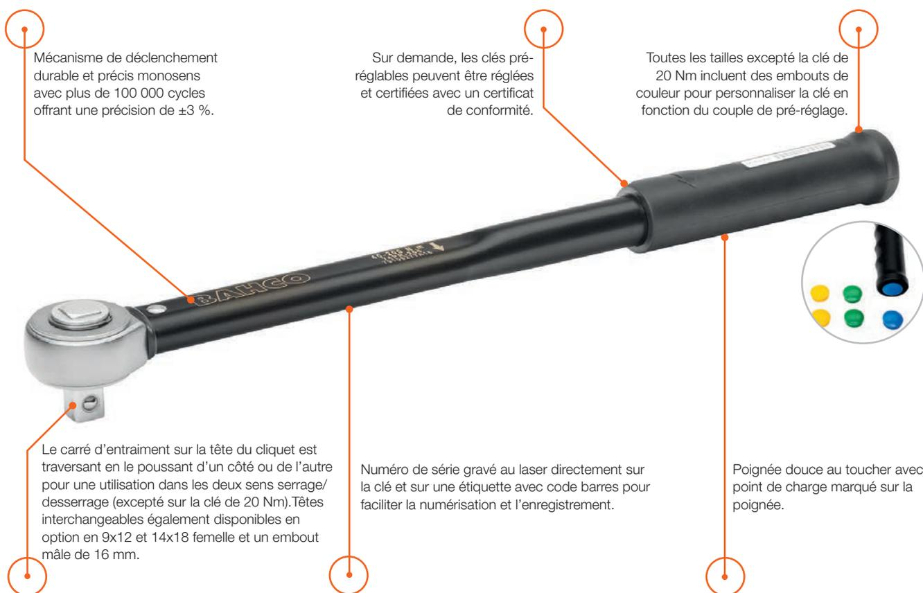
Mécanisme de déclenchement durable et précis monosens avec plus de 100 000 cycles offrant une précision de  $\pm 3\%$ .
